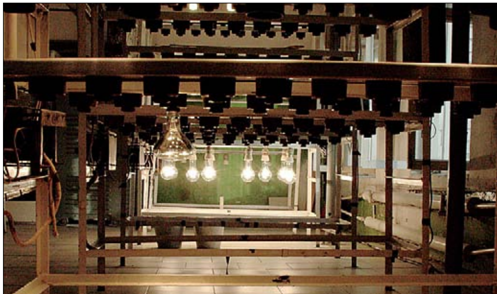
Каждая партия готовых ламп проходит проверку светового потока на фотометре.
