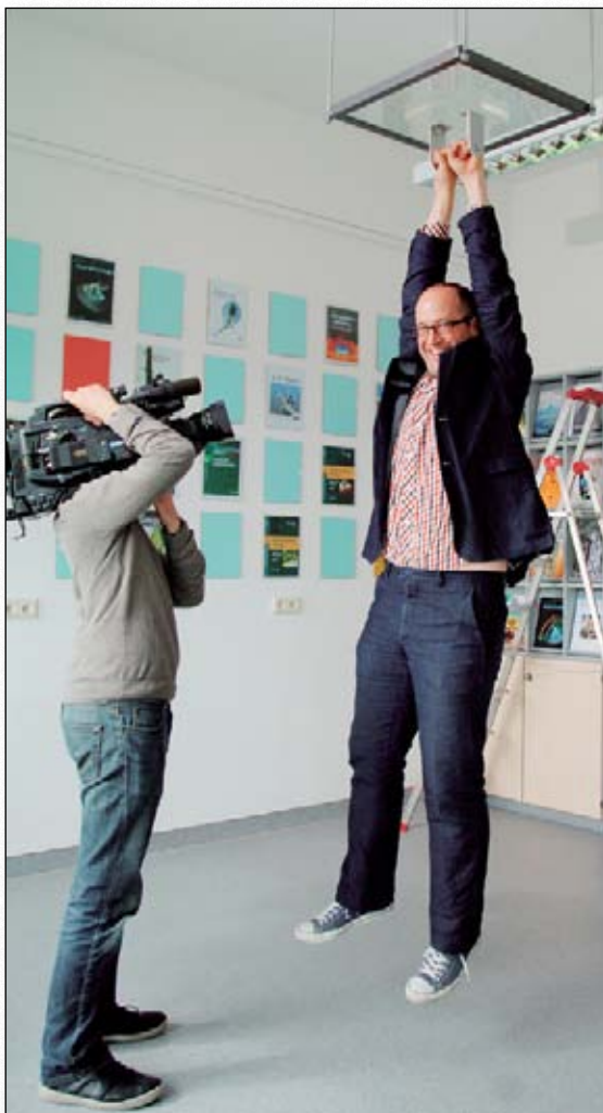
Бесклеевая плёнка Gecko Nanoplast размером 20 \times 20 см способна удерживать на весу взрослого человека. Фото Claudia Eulitz. Christian — Albrechts — Universität zu Kiel.
