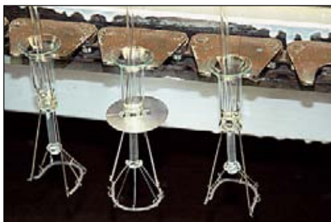
Ножки с тарелкой, штенгелем, электродами и спиралью на двух держателях собраны. Теперь их можно поместить в колбу.
