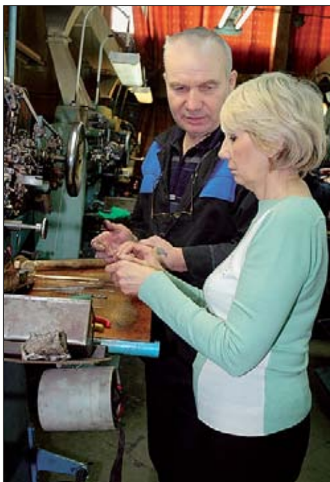
Электроды сваривают из трёх проволок: медной, стальной и ферроникелевой. Операция эта требует тщательной наладки сварочного автомата. Начальник производства Нина Лепшова и сварщик Валерий Тимофеев возле установки для сварки электродов.
