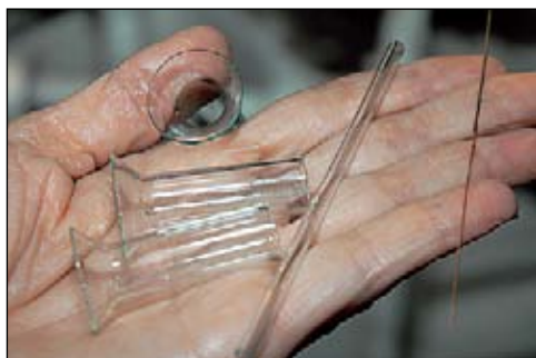
Так выглядят тарелка, штенгель и электрод. Собранные вместе, они станут основой лампы.
