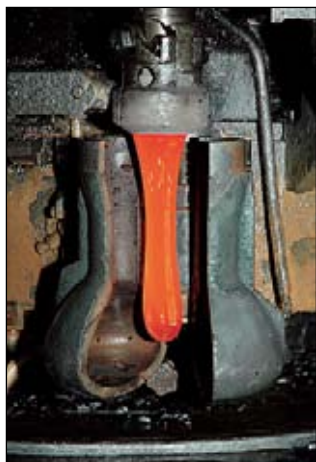
Заготовка — раскалённая стеклянная капля — попадает в форму и под давлением воздуха превращается в колбу.
