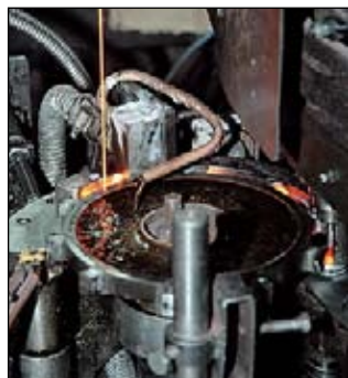
Яркая вертикальная линия на фото — это струйка расплавленного чёрного стекла, которым заливают цоколь лампы при сборке. Когда оно остынет, действительно станет чёрным.
