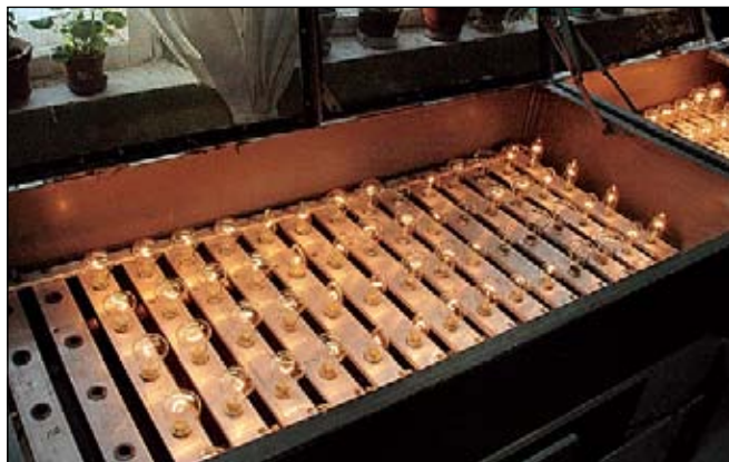
На специальном стенде проверяют качество ламп. Здесь можно заставить их гореть при напряжении от 125 до 270 В.
