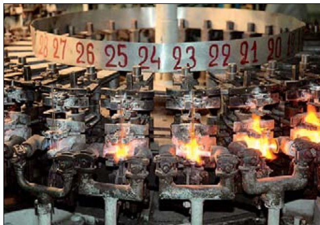
Огонь в жизни лампочки появляется задолго до того, как она начинает светить, уже на стадии изготовления штенгеля — трубочки для откачки из колбы воздуха и заправки азотно-аргонной смесью.
