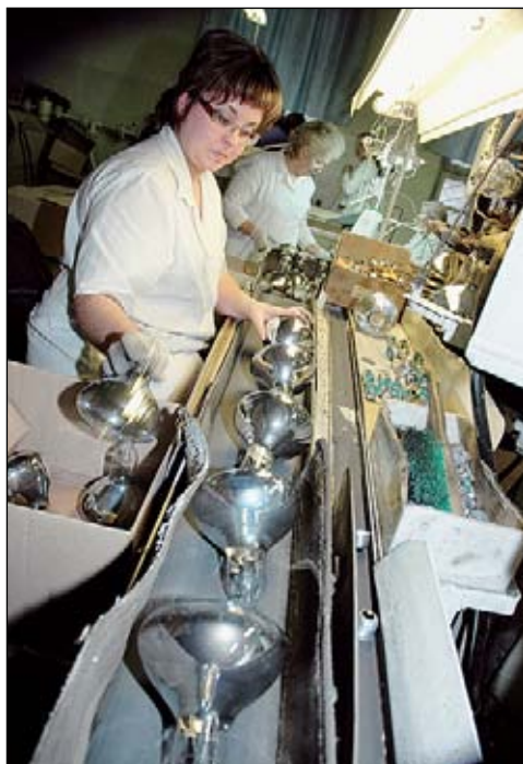
Установка цоколя на большие лампы — операция очень ответственная. На автомате цоколевания ламп работает оператор Евгения Васильева.
