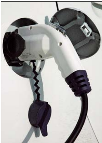
Вместо горловины бензобака за лючком на правом борту автомобиля спрятана розетка системы зарядки аккумулятора.
