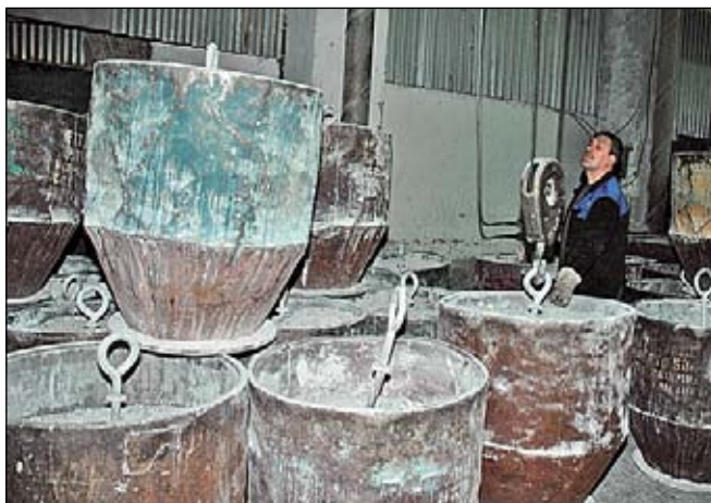
Стекловар Николай Калинин с помощью мощного тельфера переносит ёмкость с шихтой в стекловаренную печь.
